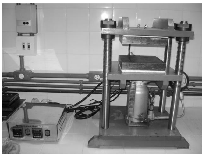
Figura 3.4: Prensa hidráulica usada para formar os “tapetes”.
