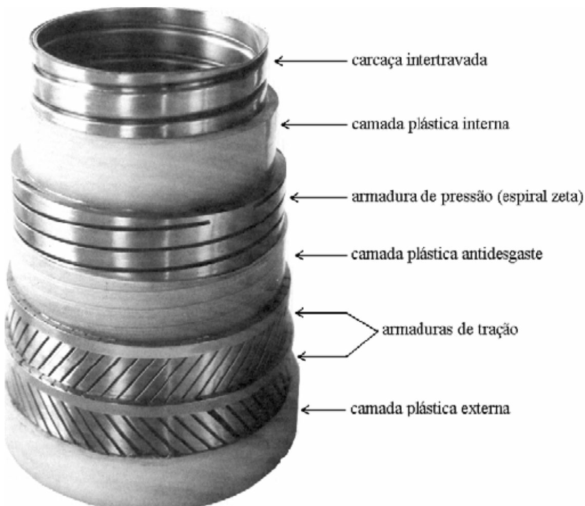
Figura 1.18: Estrutura típica de uma linha flexível Fonte: RIBEIRO, 2005
