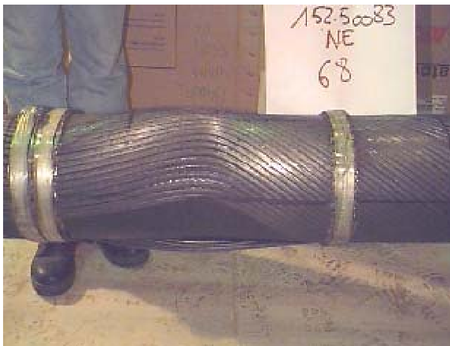
Figura 1.23: Flambagem Fonte: Visita técnica, 2008
