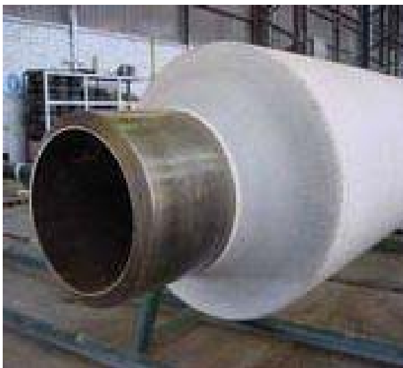
Figura 1.3: Revestimento de Concreto Fonte: ALMEIDA, 2005
