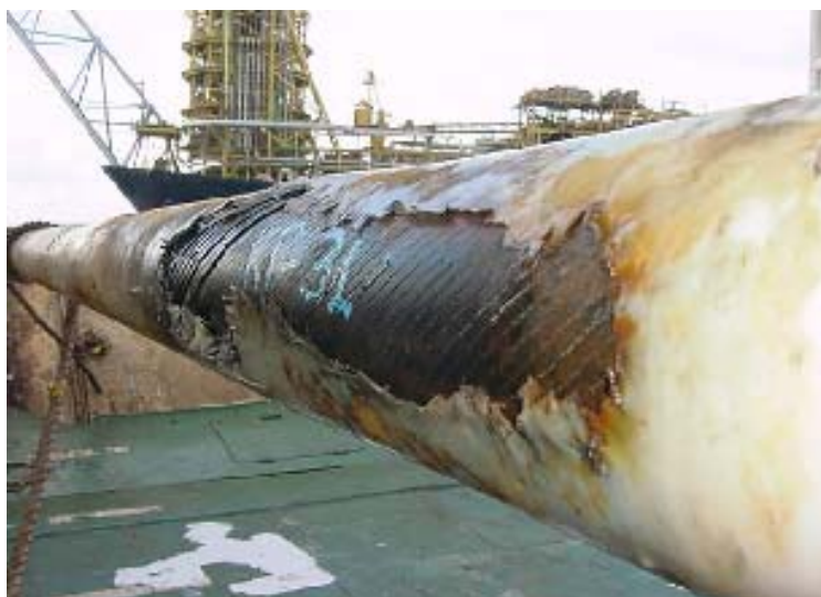
Figura 1.26: Abrasão da camada plástica externa Fonte: Visita técnica, 2008
