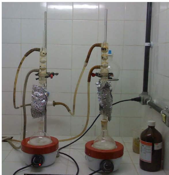
Figura 3.4: Extrator de soxhlet Fonte: Laboratório Tecpol - IPRJ
