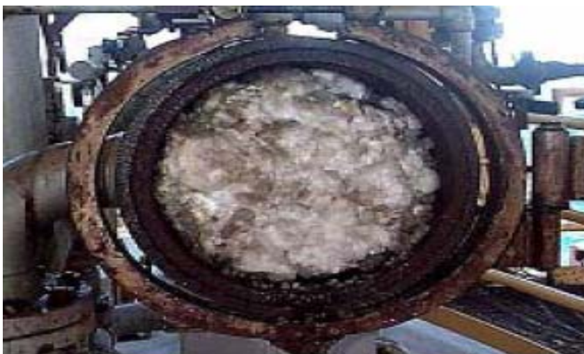
Figura 1.2: Formação de hidratos Fonte: ALMEIDA, 2005
