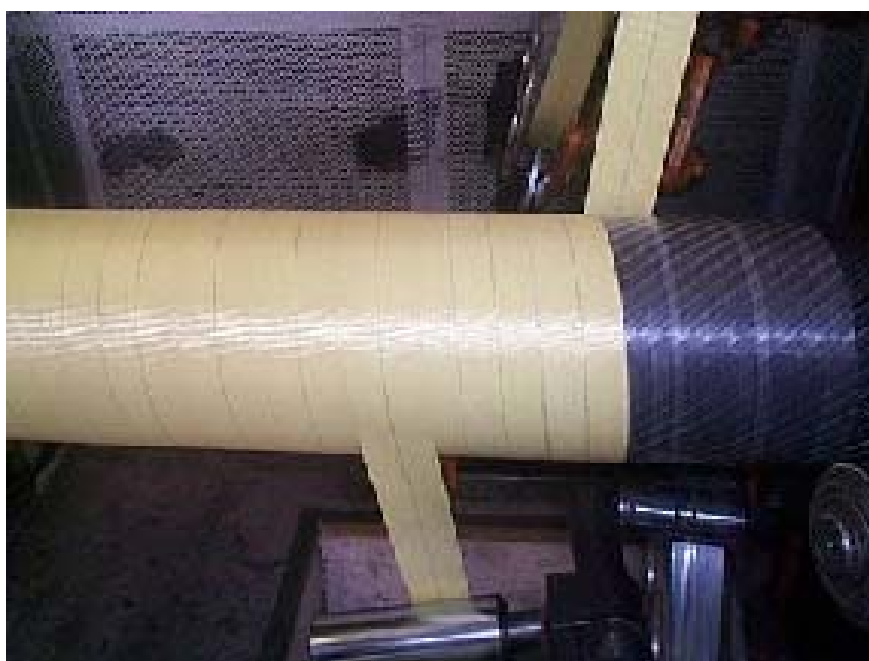
Figura 1.22: Fita anti-flambagem Fonte: Visita técnica, 2008
