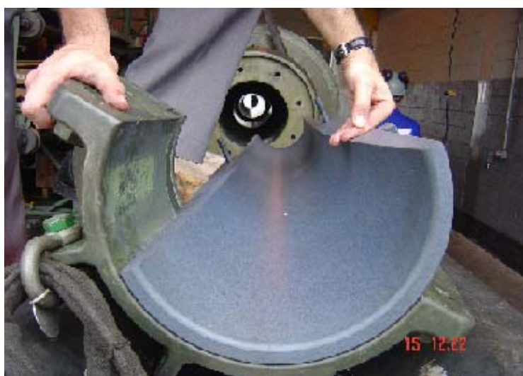
Figura 1.27: Colar de poliuretano Fonte: Visita técnica, 2008
