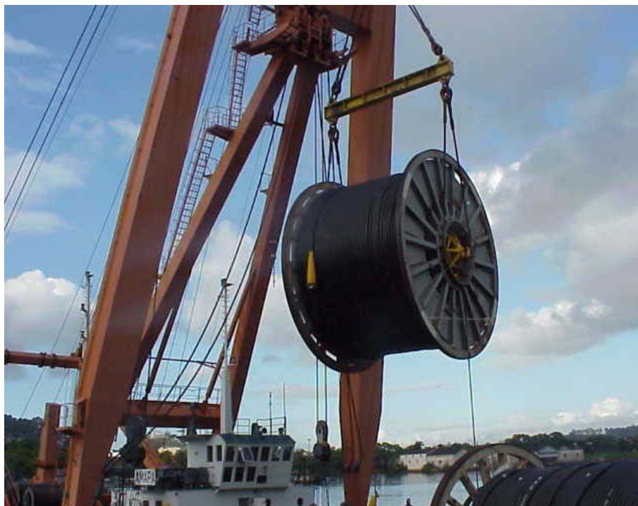
Figura 1.5 (b): Bobina para armazenamento de linhas flexíveis – Com linha flexível. Fonte: Visita técnica, 2008
