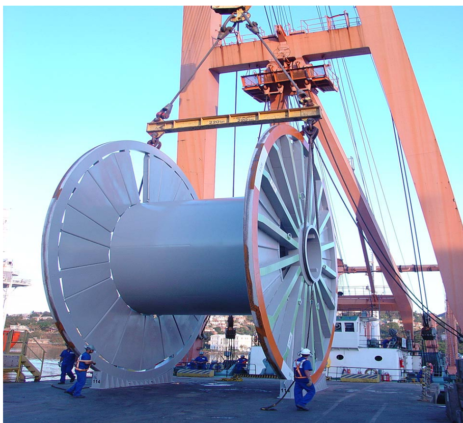
Figura 1.5 (a): Bobina para armazenamento de linhas flexíveis – Sem linha flexível. Fonte: Visita técnica, 2008
