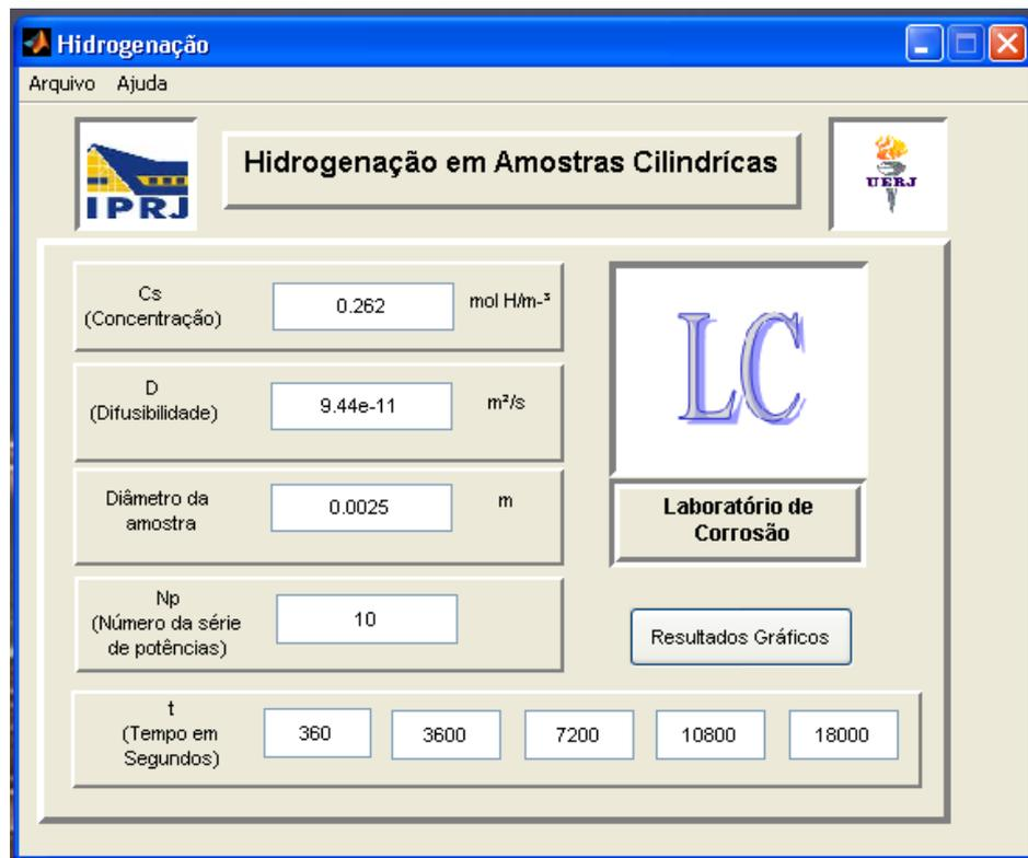
Figura 3.13 - Interface do programa computacional - MATLAB para obtenção do perfil de concentração de hidrogênio nos corpos de prova (REIS, 2009).
