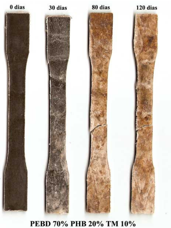
Figura 4.11a – Corpos-de-prova da mistura ternária PEBD/PHB/TM (70/20/10)
