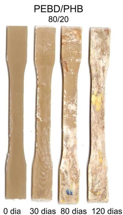
Figura 4.10b - Corpos-de-prova formados pela mistura PEBD/PHB (80/20).
