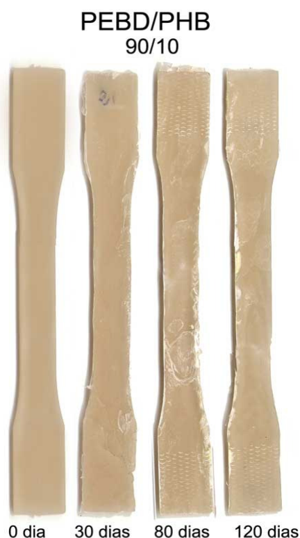
Figura 4.10c - Corpos-de-prova formados pela mistura PEBD/PHB (90/10).
