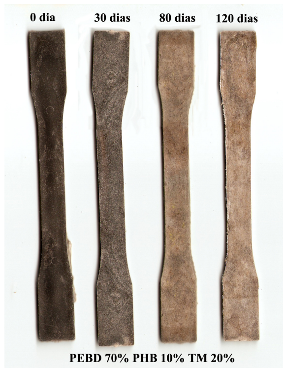
Figura 4.11b – Corpos-de-prova da mistura ternária PEBD/PHB/TM (70/10/20)
