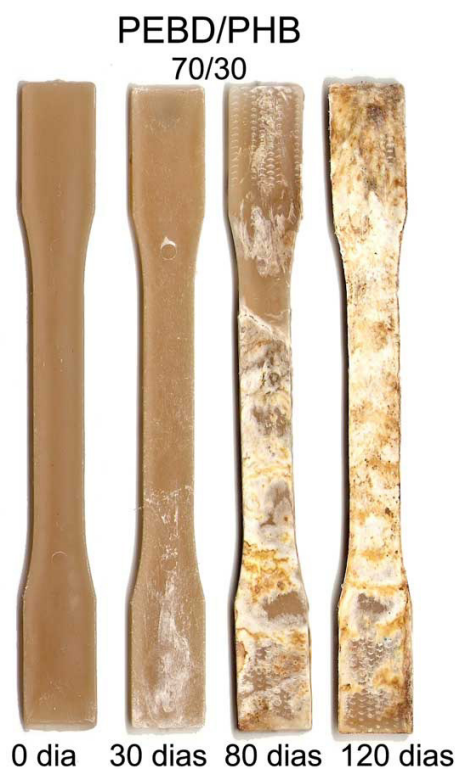
Figura 4.10a - Corpos-de-prova formados pela mistura PEBD/PHB (70/30).
