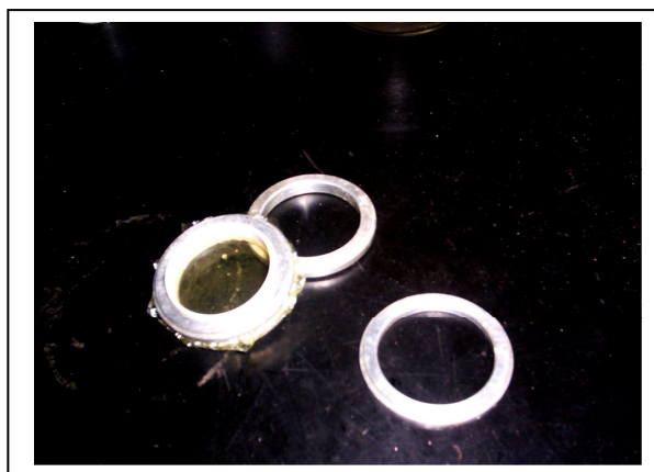
Figura 4.8 – Exemplo de amostra de uma resina epóxi curada e os moldes de alumínio onde foi inserido o molde de PVC com a resina líquida.
