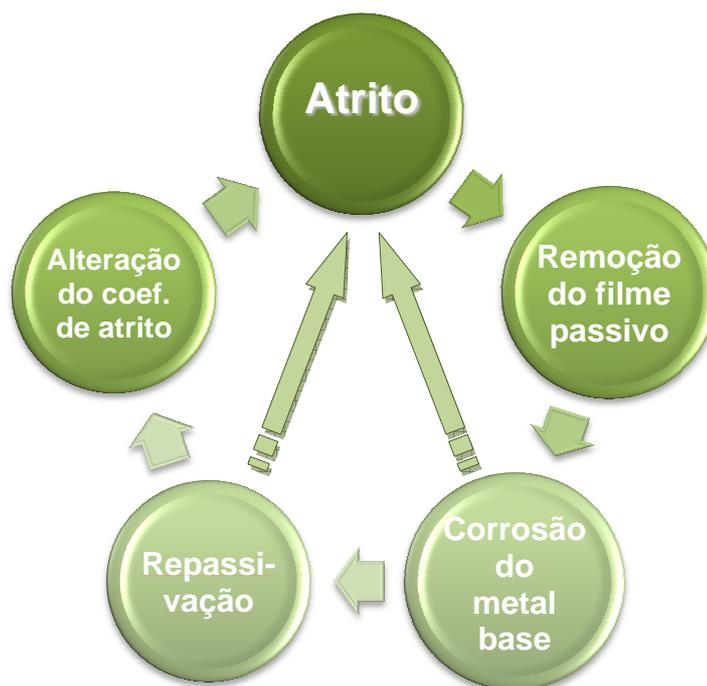
**Figura 2.4 - Diagrama representando a sinergia entre os processos mecânico e eletroquímico.**
