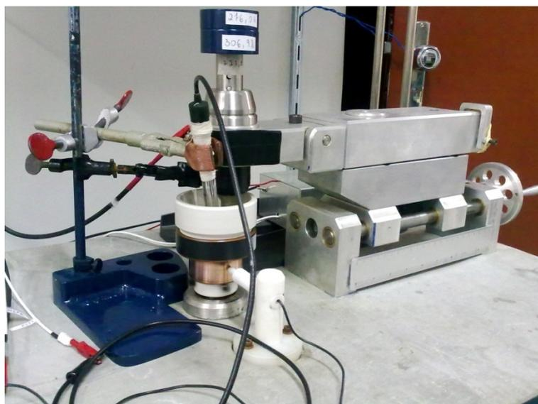
**Figura 3.4 – Tribômetro do tipo pino-no-disco preparado para ensaios de tribocorrosão.**
