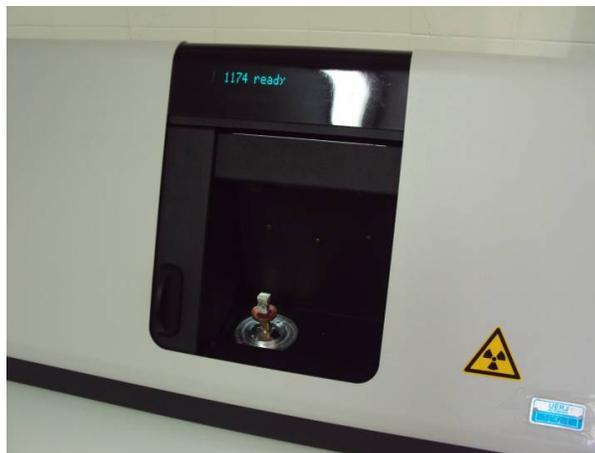
Figura 44 - Posicionamento da amostra no microtomografo de raios X.
