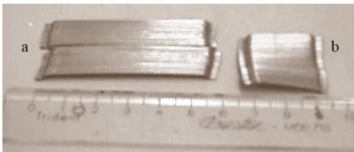
Figura 10 - Fibras de aço longas (a) e curtas (b)
