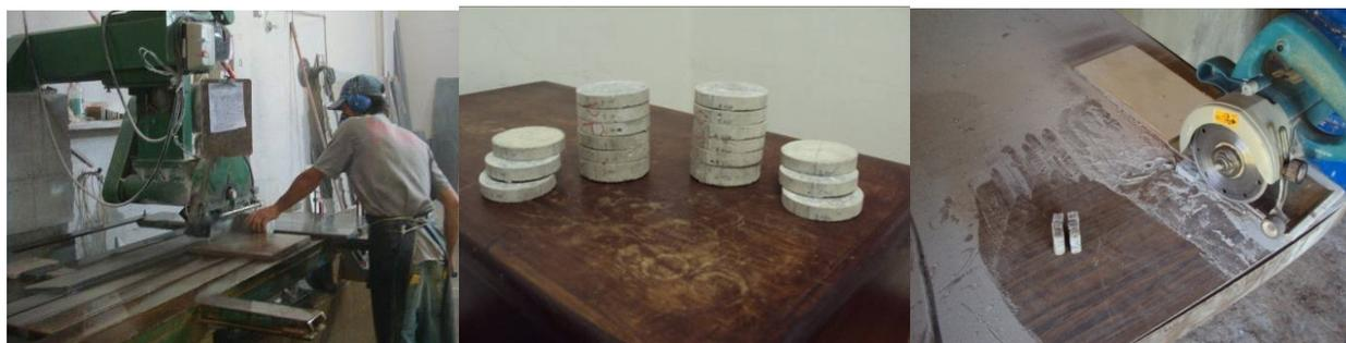
Figura 38 - Corte dos corpos de prova de concreto reforçado com fibras de aço e polipropileno com serra mármore industrial e manual.
