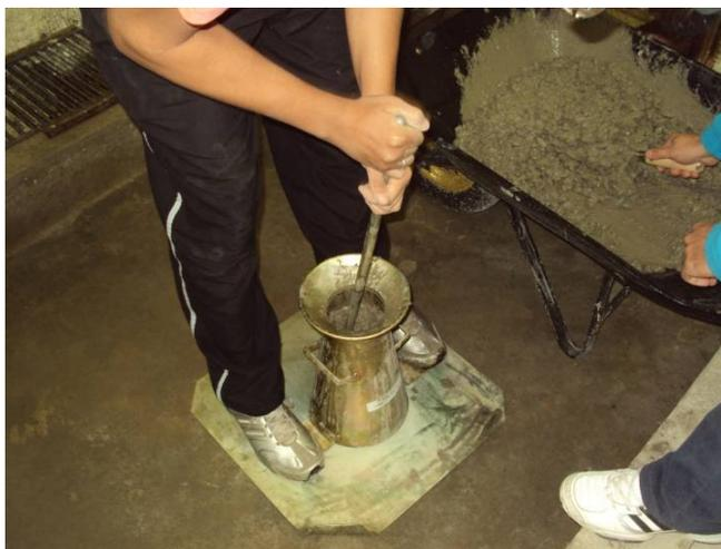
Figura 29 - Ensaio de abatimento do tronco de cone.
