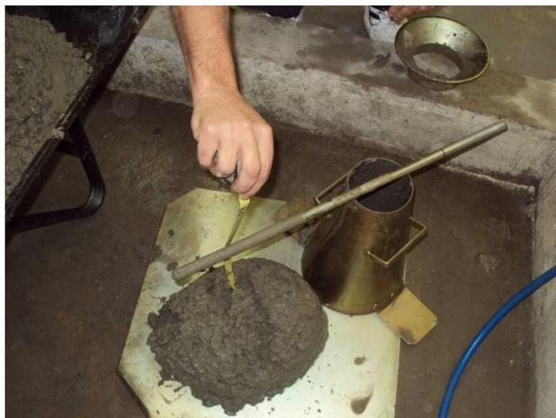
Figura 30 - Determinação da consistência do concreto pelo abatimento do tronco de cone.
