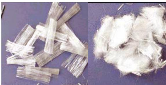
Figura 2 - Fibrilas finas em forma retangular e na forma de mono-filamentos cilíndricos finos
