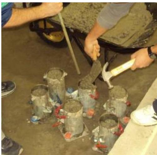
Figura 32 - Golpeamento por camadas nos corpos de prova de concreto.
