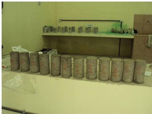
Figura 35 - Corpos de prova de concreto desformados.
