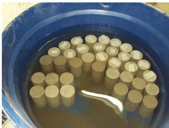
Figura 36 - Tanque de cura dos corpos de prova de concreto
