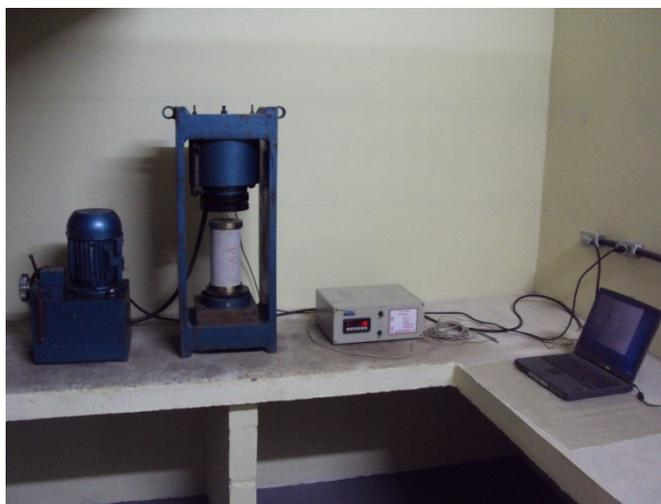
Figura 48 - Ensaio de compressão uniaxial em CRF de aço e PP.
