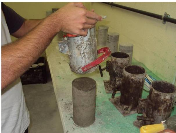
Figura 34 - Desforma dos corpos de prova de concreto.
