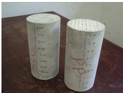
Figura 37 - Marcação dos corpos de prova de concreto reforçado com fibras de aço e polipropileno.
