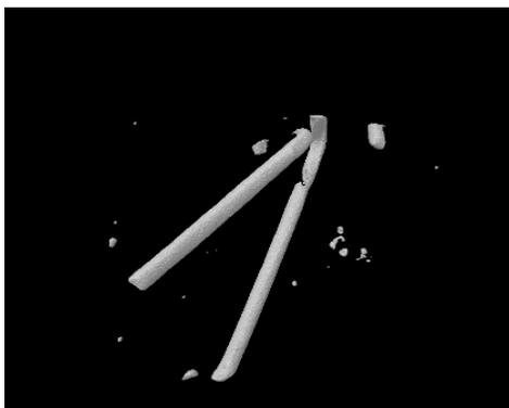
Figura 47 - Imagem em 3D das fibras no interior da amostra de concreto reforçado com fibras de aço.
