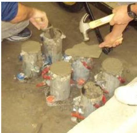
Figura 31 - Moldagem dos corpos de prova de concreto.
