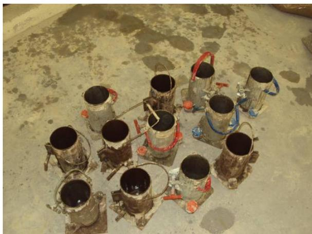
Figura 27 - Lubrificação dos moldes com óleo mineral.
