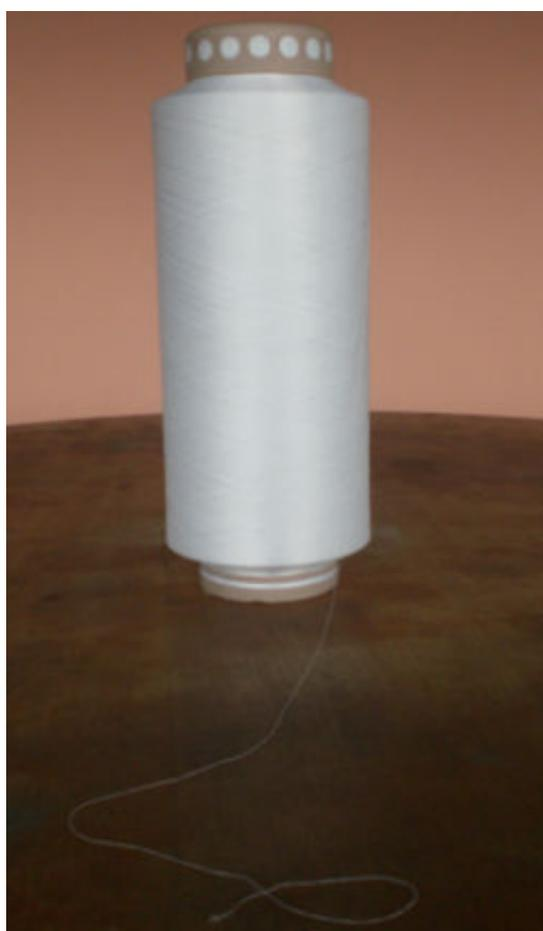
Figura 9 - Fio têxtil produzido usando-se as garrafas PET e o resíduo da confecção de poliésteres.
