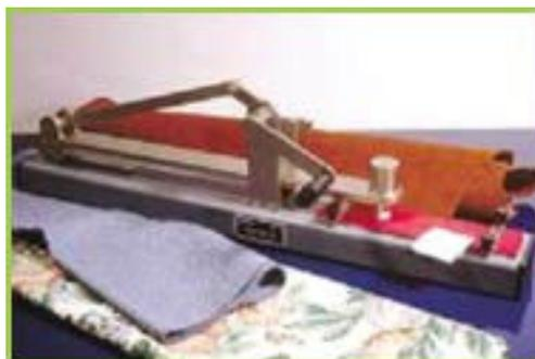
Figura 17 - Aparelho *crockmeter* [44]
