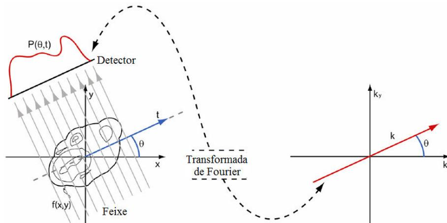
Figura 15 - Transformada de Fourier
