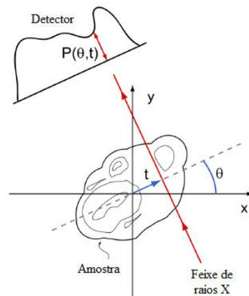
Figura 14 - Propagação de um feixe de raios X através de uma amostra
