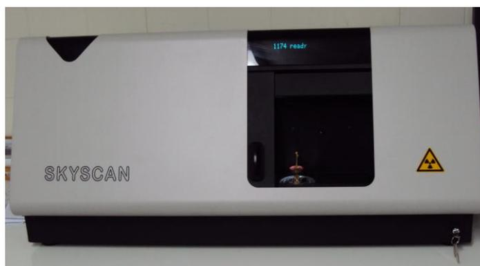
Figura 24 - Microtomógrafo da Skyscan (Modelo 1174) portando uma amostra óssea
