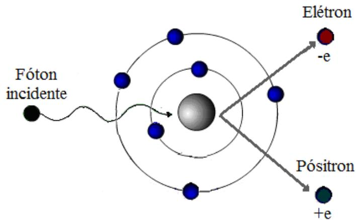
Figura 7 - Esquema ilustrando a produção de pares.
