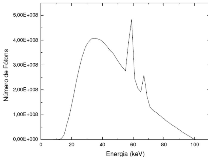
Figura 2 - Espectro de Raios X produzido por um alvo de tungstênio
