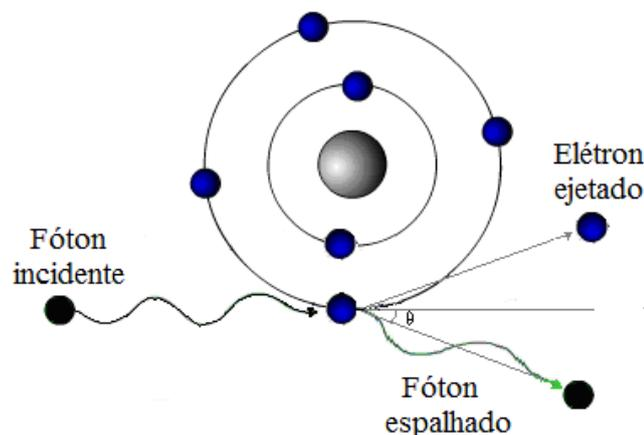
Figura 5 - Esquema ilustrando o espalhamento Compton.
