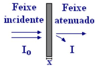
Figura 8 - Esquema ilustrando a interação da radiação com a matéria.
