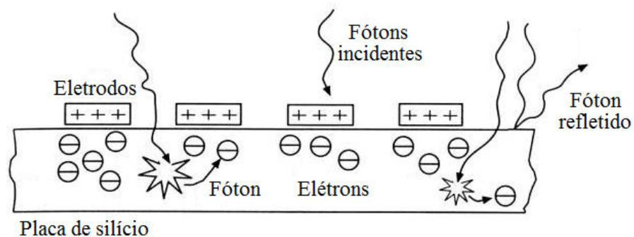
Figura 12 - Esquema representando um detector de CCD
