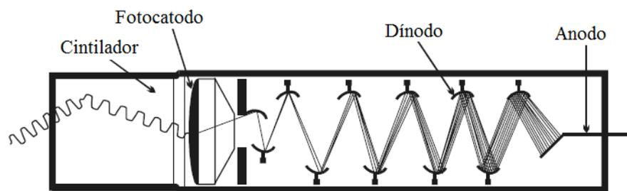
Figura 11 - Esquema representando um detector por cintilação
