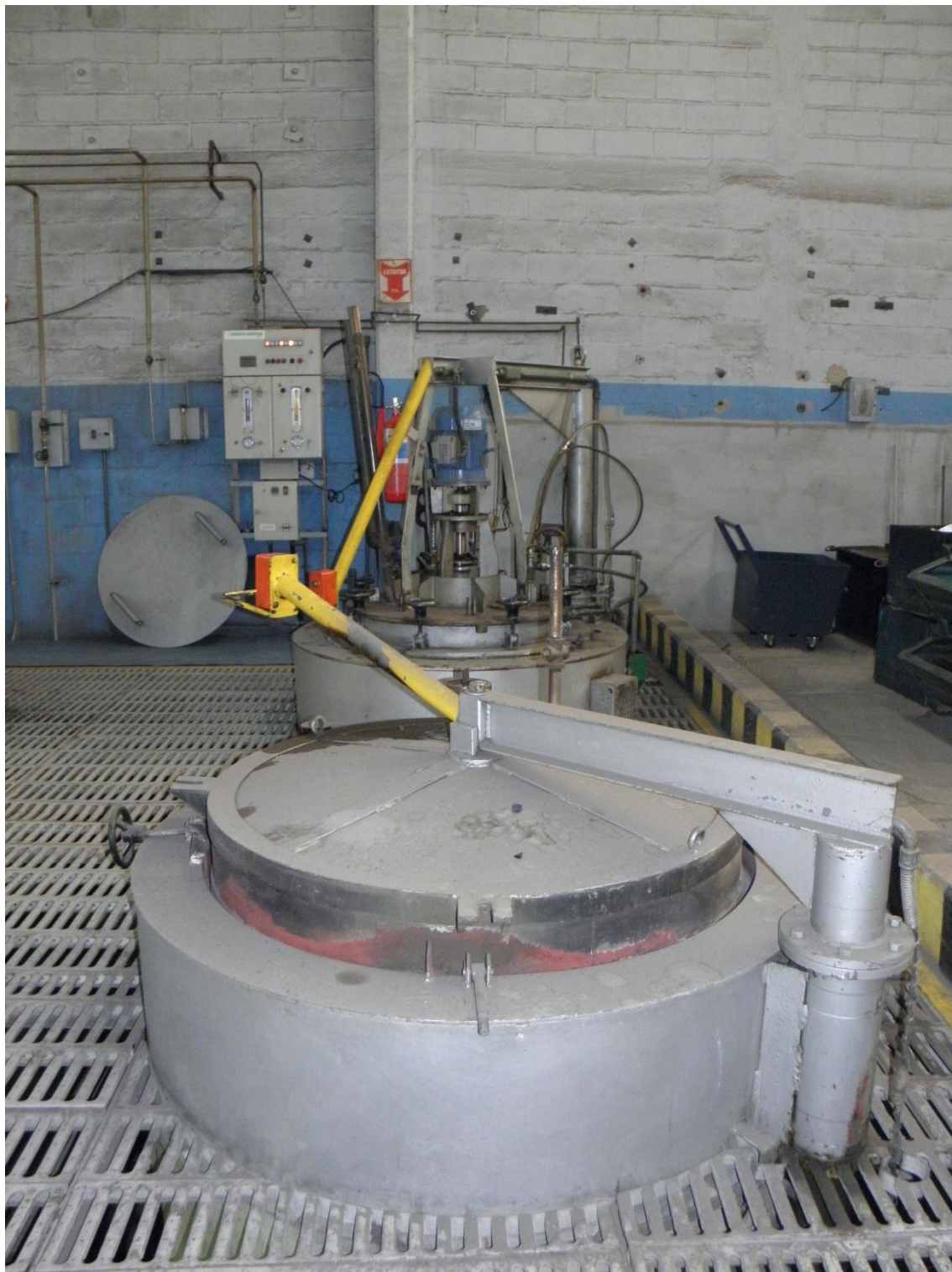
Figura 2 - Fornos de Revenimento (1º Plano) e Têmpera (2º Plano) para Temperar e Revenir as Amostras. Fonte: O autor, 2012.
