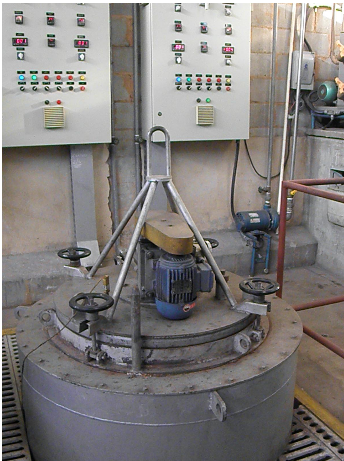
Figura 4 - Painéis de Controle e Forno Utilizado no Recozimento das Amostras. Fonte: O autor, 2012.
