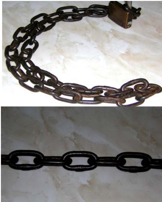
**Figura 32 – Corrente de elos redondos cementada em caixa.**
