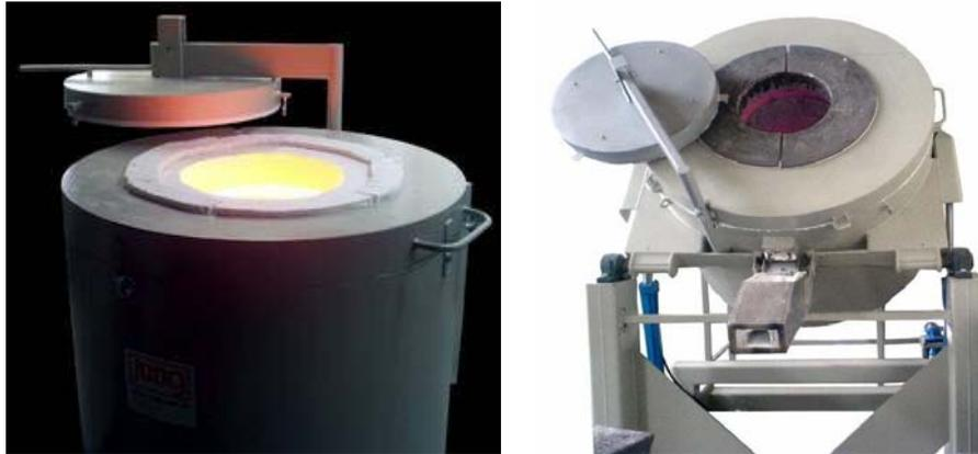
**Figura 9 – Forno para cementação líquida – com aquecimento externo**
