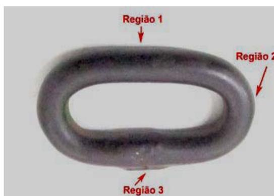
**Figura 34 - Amostra de Elo de Corrente fornecida para a Análise Química.**
