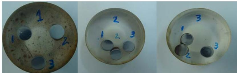
**Figura 33 – Seções de Elo de Corrente preparadas para o Ensaio de Dureza.**
