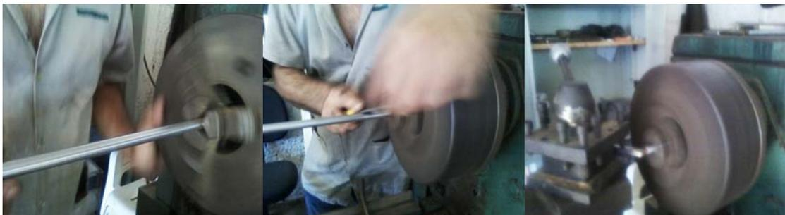
**Figura 40 – Preparo da barra de aço ABNT 1020 para cementação.**
