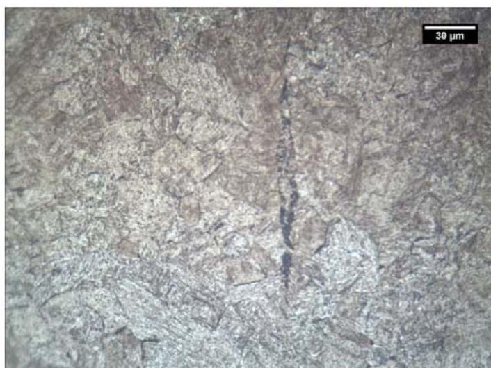
Micrografia no centro do caldeamento região 3. Observa-se falta de fusão, microestrutura constituída por martensita revenida.
