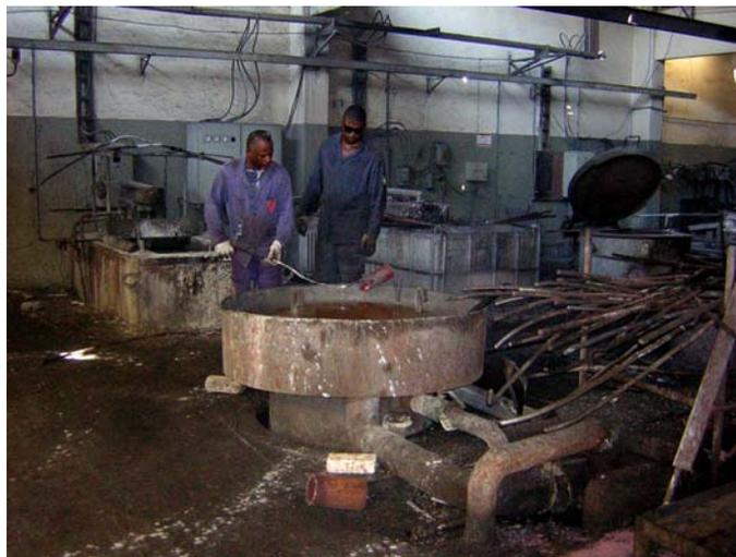
**Figura 8 – Peças sendo temperadas, após cementação.**
