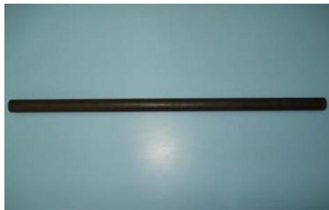
**Figura 39 – Barra de aço ABNT 1020 bitola 12,7 mm (1/2 polegada).**
