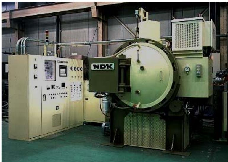
**Figura 17 – Forno de cementação a plasma marca NDK Incorporated, Modelo PMF-754.**
