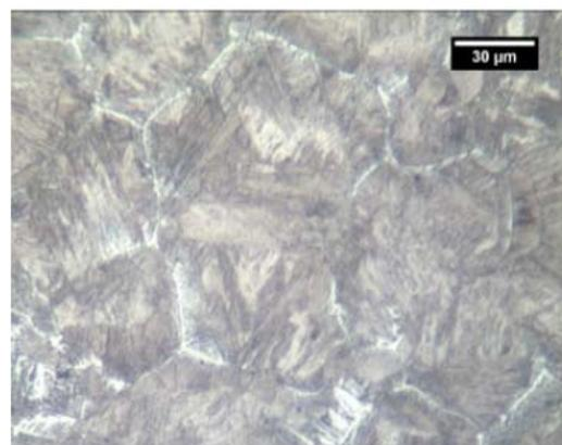
Micrografia da camada constituída por martensita revenida e austenita retida. Micrografia do núcleo constituída por martensita revenida e ferrita de Widmannstätten em contorno de grão.
