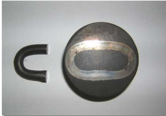
**Figura 35 – Elo de corrente embutido ao lado da outra metade seccionada.**
