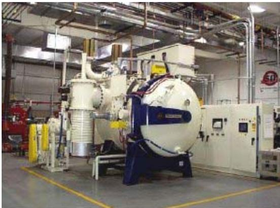
**Figura 15 – Forno de câmara simples.**
