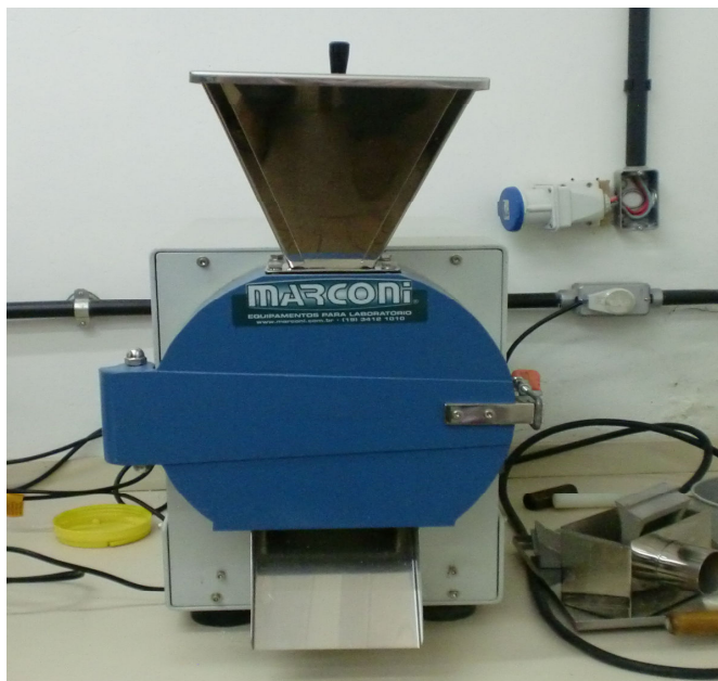
Figura 12 - Pulverizador, marca Marconi, utilizado na granulação do EPDM para redução da granulometria original (TECPOL/IPRJ)
