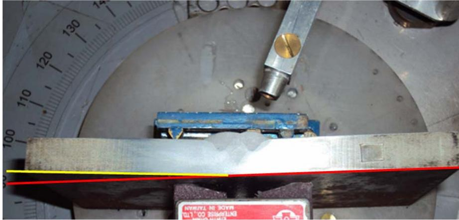
Figura 5.2: Deformação angular ocorrida após o processo de soldagem MIG.
