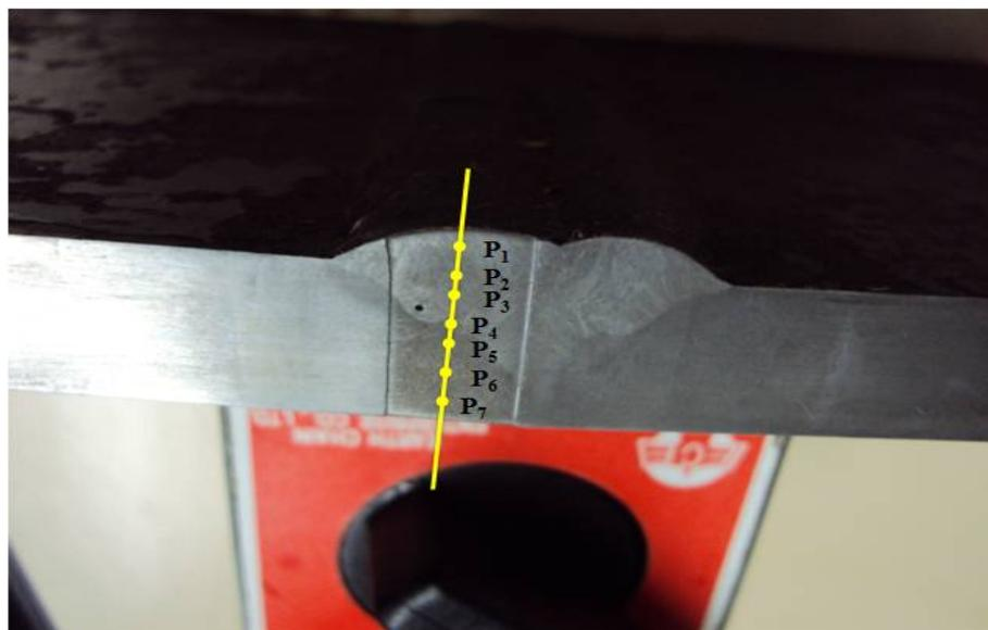
Figura 5.13: Pontos de análise na secção transversal (Aço A36).
